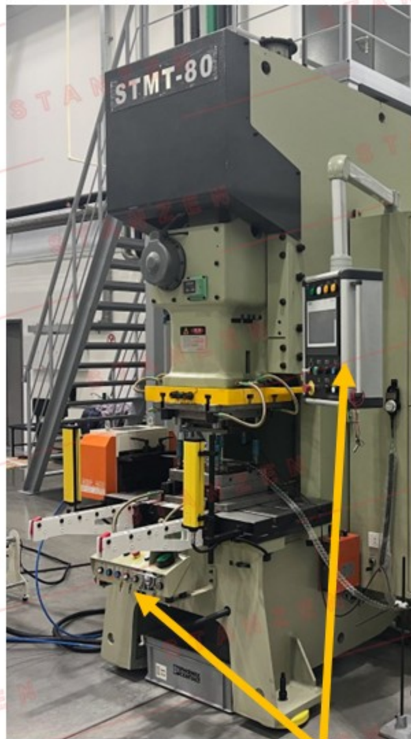
Система управления СБСШ интегрирована в действующее управление пресса
