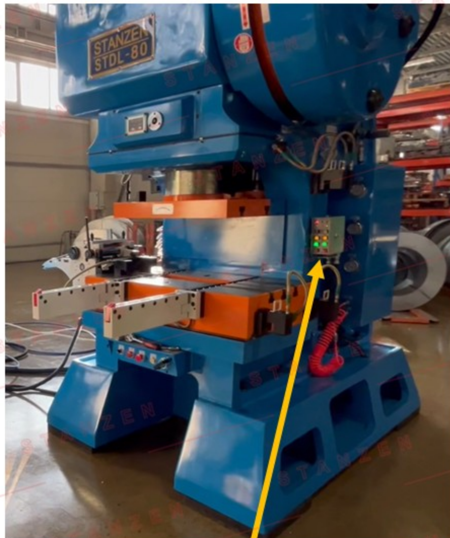
Система управления СБСШ вынесена отдельным пультом управления (модернизация)
